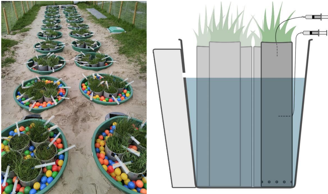
Figuur 3. Links: een overzicht van de veenkolommenproef. Iedere ton bevat 1 experimentele behandeling met daarin vijf veenkolommen. Rechts: een dwarsdoorsnede van een tank met daarin vijf veenkolommen. In iedere veenkolom zijn twee rhizons geïnstalleerd. De gekleurde ballen in de tonnen zijn bedoeld om de verdamping tegen te gaan en algengroei in de tonnen te voorkomen.
